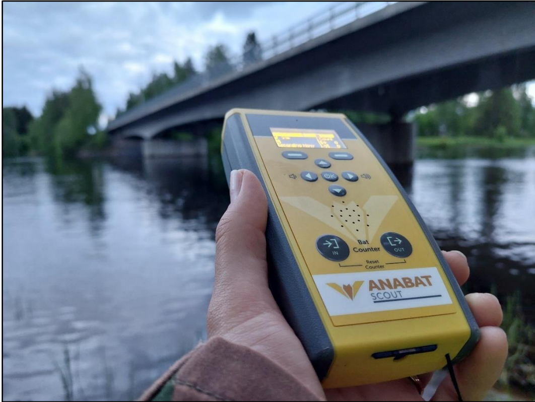
Kuva 5-1. Lepakkokartoituksessa käytetty Anabat scout -detektori havaitsee lepakkojen kaikuluotausääniä muuttaen ne ihmiskorvin kuultavaksi. Detektori kertoo automaattisesti havaitun äänenkorkeuden kilohertseinä, minkä avulla voidaan tehdä lajimääritys.
