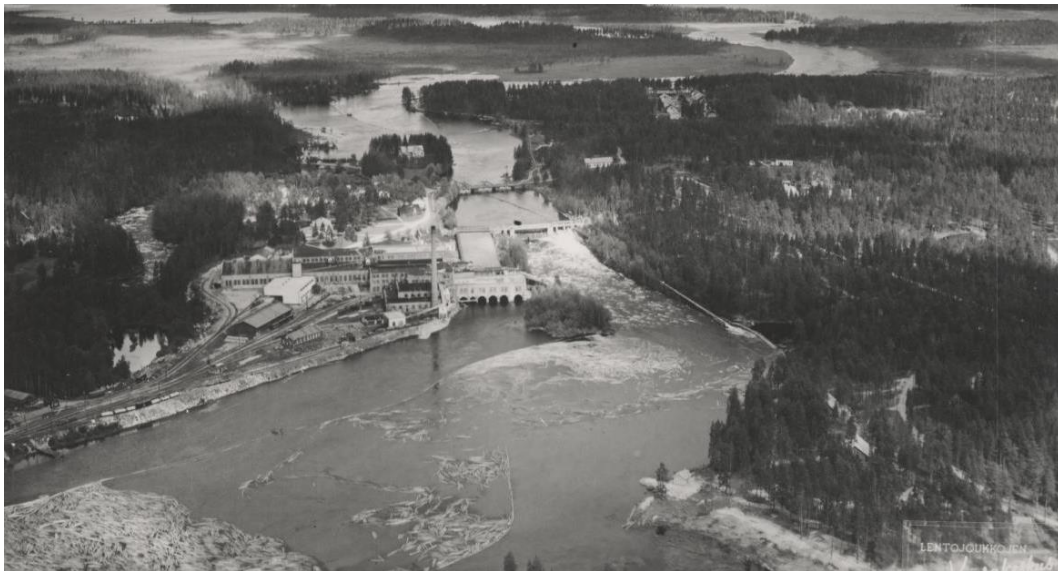
Ilmakuva Pankakoskelta. Kuvassa näkyy Lieksanjoen vesistöä ja keskellä Pankakosken tehdas. Keskeällä jokea tehtaan vieressä on Hopeasaari. Kosken oikealla rannalla erottuu tukkien uittoränni. Alajuoksulla näkyy vedessä runsaasti uivaa puutavaraa. Valokuva Toivo Saklen. Pielisen museo. (Kuvälähde finna.fi).
